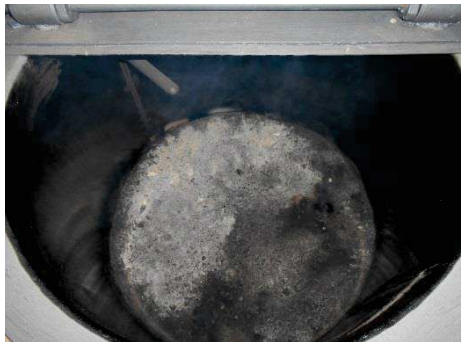
8時間後・炭化した為煙もなくなる。 再投入可能
