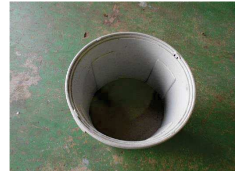
12時間後減容率は約4～5分の1となる。 有益なセラミック灰となる。
